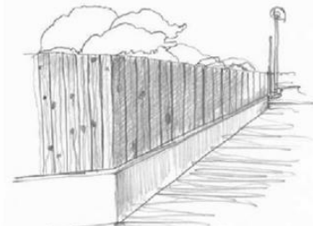
Clôture en palissade de bois sur muret en maçonnerie
