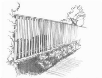
Clôture en planches de bois à claire-voie sur muret en maçonnerie
